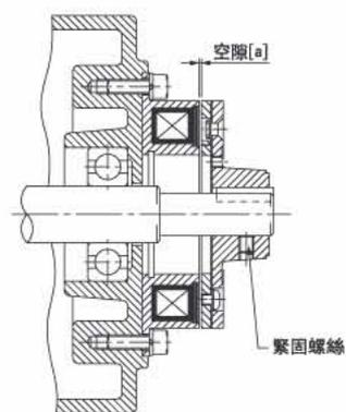
是一種安裝簡單的一種機型。可以輕鬆地安裝到現有機械上的需要停止、固定等的軸端部，而無需進行大幅度的改造及變更。空隙 [a] 的設定只需移動電樞 H 型，用定位螺絲進行固定，操作極其簡單。
