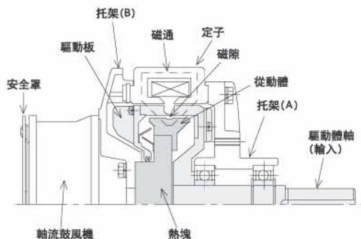
PB-V 型磁粉制動器 (示意圖)
